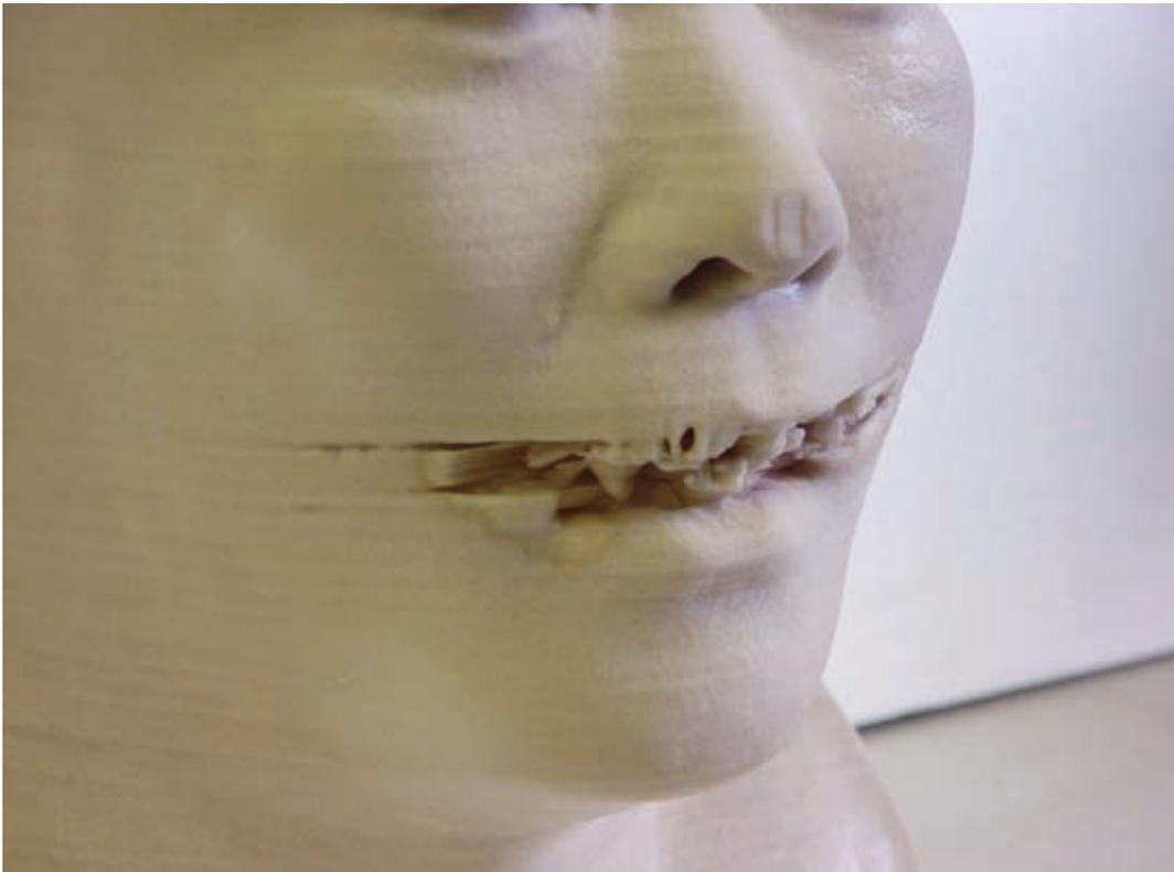
写真3 アーチファクトを反映させて、正確な造形ができなかった第一次模型。
