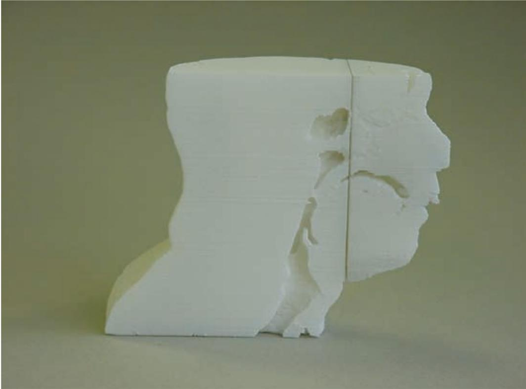
写真2 予備実験において作成したソリッドモデルの模型。声道は実現しているが、空洞全体を観察することができなかった。
